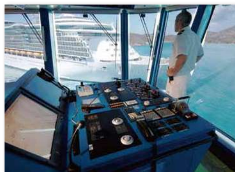
Kongsberg Maritime社製 K-Bridge用オペレーターステーション
