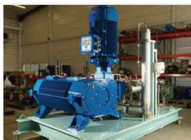
低速ガス重油2元燃料エンジン向け Cryostar社製高圧ポンプ(300bar)
