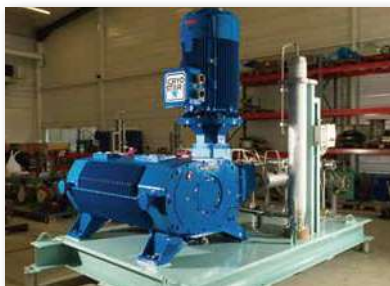
低速天然气重油双燃料发动机用 Cryostar公司制造的高压泵(300bar)
