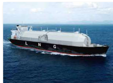
连续槽罐盖球罐型LNG船 豌豆角 【照片提供：三菱重工业株式会社长崎造船厂】
