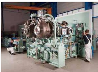
Cryostar公司制造的LNG船用DFDE系统 第4代气体压缩机
